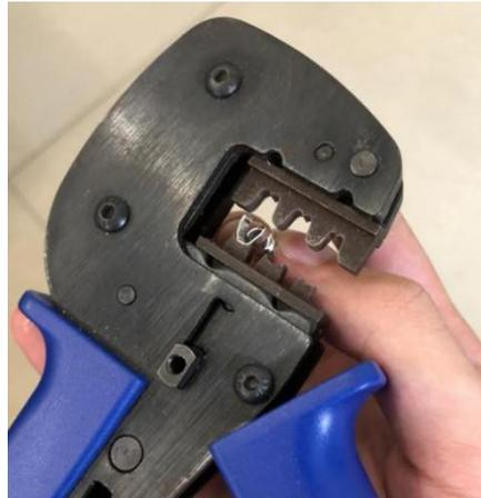
Abra al máximo las pinzas de crimpar y coloque la apertura del terminal de crimpar hacia arriba en la posición correspondiente.
