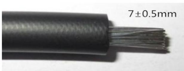
Pele la capa protectora y el aislamiento del cable. 7mm Longitud izquierda y derecha.
