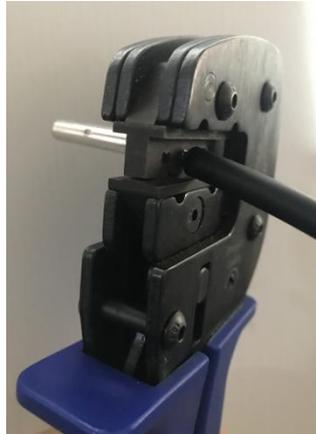
Inserte el cable pelado en la posición de crimpado de modo que el aislamiento del cable quede cerca del terminal y comprima completamente los alicates de crimpado. Inserte el cable pelado en las lengüetas de crimpado del terminal hasta que el protector del cable y el aislamiento toque el terminal. Presione completamente el crimpador y apriete el terminal.
