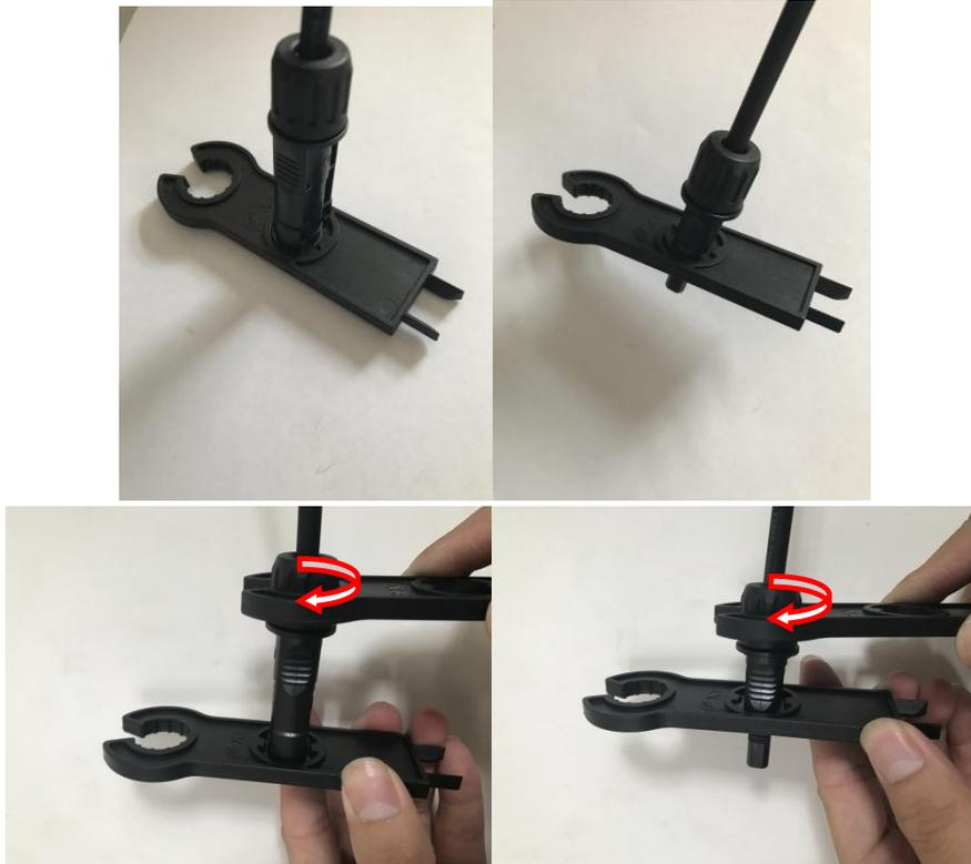
Use el orificio en el medio de la llave para sujetar el conector y use el broche en la cabeza de la otra llave para apretar la tuerca en el sentido de las agujas del reloj.
