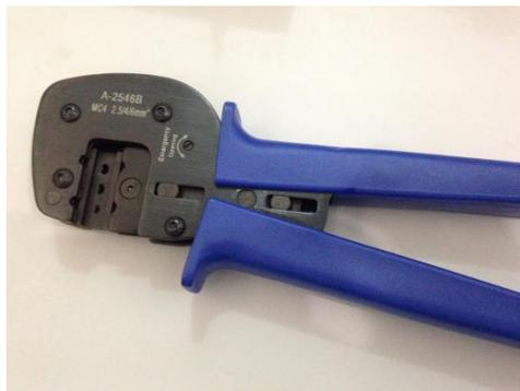
Rango de prensado: 2,5 mm<sup>2</sup> ~ 6 mm<sup>2</sup>
