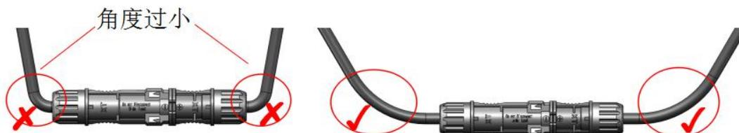
**Observación:** Consulte los requisitos detallados del fabricante del cable para conocer el radio de curvatura mínimo **Observación:** Según los requisitos de los fabricantes de cables
