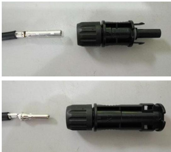
Inserte el conector del terminal engarzado en elPV-XT101.1 hasta que escuche un clic que indica que está en su lugar, tire del cable ligeramente para verificar si las partes metálicas están en su lugar.
