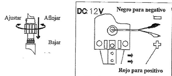
5. El producto no puede conectarse directamente al voltaje alterno (110V), pues si se conecta, será peligroso.
